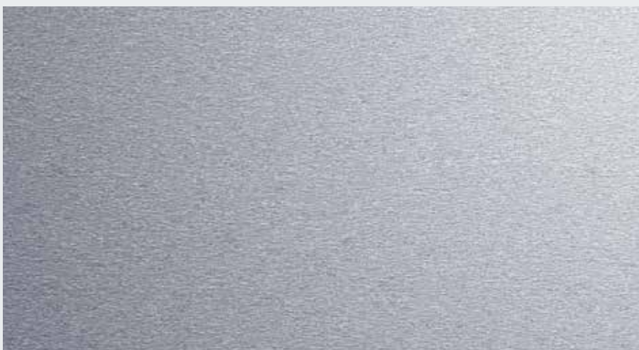
Stal nierdzewna V2 A, 1.4301, K 240
